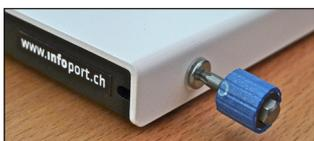
2. **info port öffnen:** mit Schlüssel 4 Schrauben zirka 4mm herausdrehen (müssen NICHT ganz entfernt werden), Aussenblech zur Seite legen.
